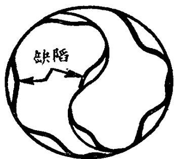
图 5 纏絲缺陷示意图
